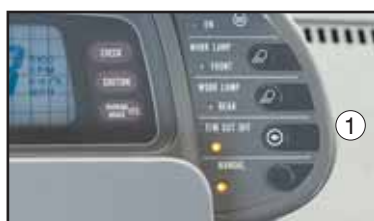
1. Attivazione stacco trasmissione 2. Impostazione stacco trasmissione
